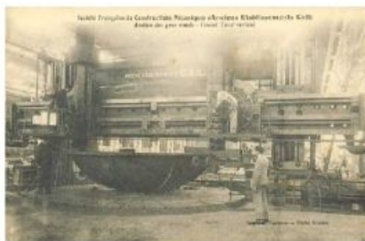
Fig. 80 - Atelier des gros outils - Grand tour vertical.
