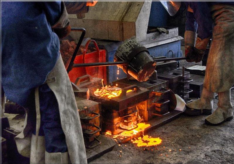
**Bas** : Coulée de fonte dans un moule. Le moule a débordé et/ou le moule a « chié » (fuite de l'alliage liquide) Parade : verser du sable sec immédiatement afin d'éviter les projections du liquide.
