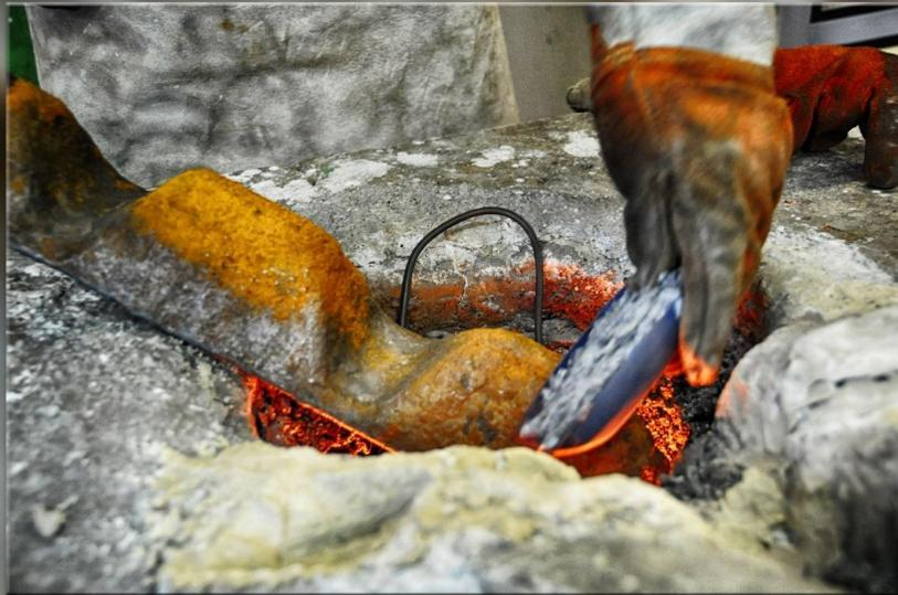
Fusion fonte au four à induction. Phase de préchauffage d'un lingot avant enfournement.
