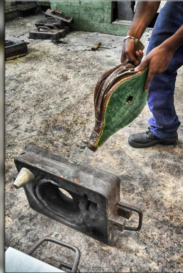
**Gauche** : Phase de remoulage pour la réalisation d'un corps de pompe. On voit un noyau permettant d'évider l'intérieur de la pièce. Un tube de colle réfractaire permet de créer le cordon qui fait le tour du moule afin d'étanchéifier ce dernier à la coulée.
