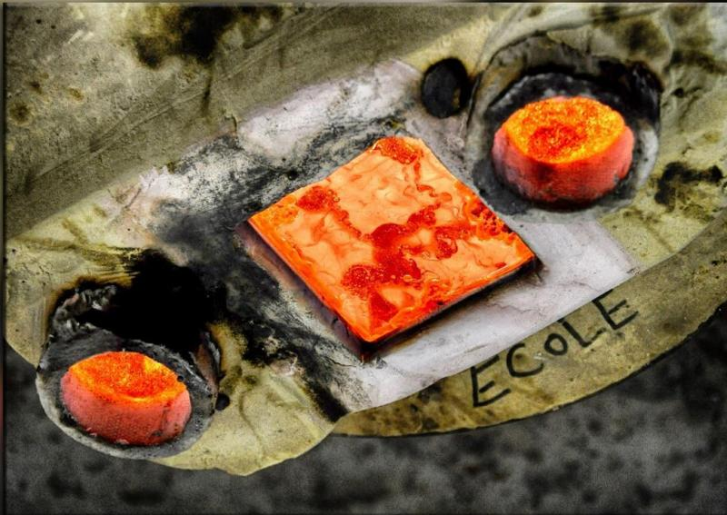
**Bas :** Coulée de la cloche de l'Ecole Supérieure de fonderie. La pièce, coulée à température de 900°C, est en début de solidification. Seuls l'entonnoir et deux masselottes sont visibles. Les nuances d'orange sont dues aux impuretés qui remontent par décantation. Vue de dessus. Trois élèves de l'ESF ont réalisé le moulage dans la fonderie Cornille-Havard à Villedieu-les-Poêles (Manche).
