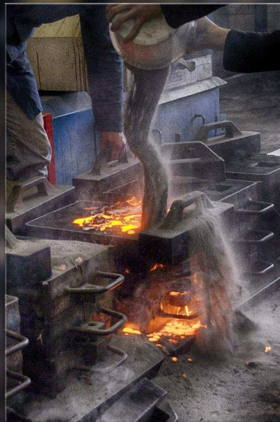
**Gauche** : Four de fusion à induction (fonte). Max procède au saupoudrage de laitier dégrasant (sorte de sable siliceux) favorisant l'agglomération des crasses. En arrière-plan, l'armoire électrique nécessaire à la puissance du four.
