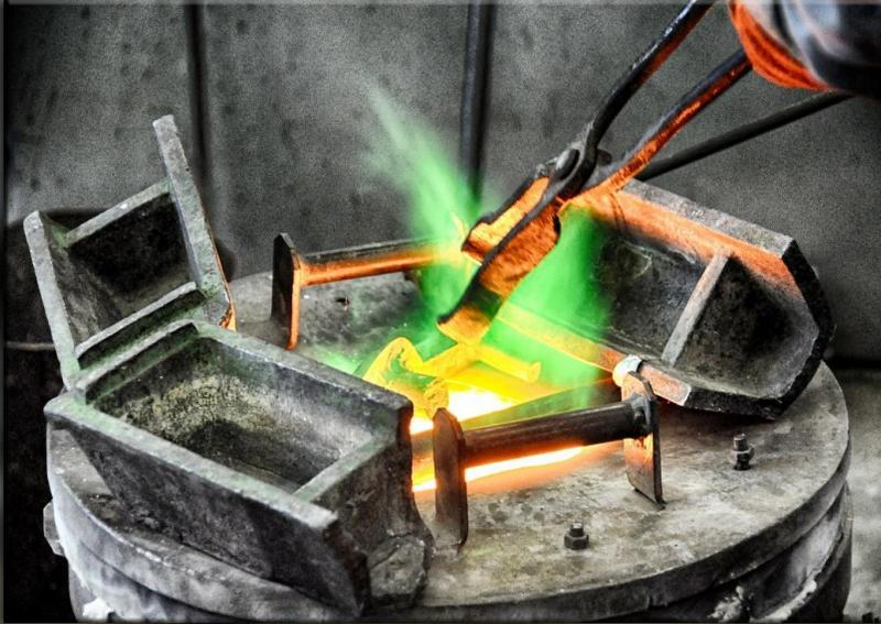
**Haut :** Fusion de bronze au four à gaz propane. La vapeur d'oxyde de cuivre qui brûle donne cette couleur verte. Préchauffage des lingotières qui recevront le reste de l'alliage liquide. La pince sert à positionner des morceaux de bronze à fondre (alimentation du creuset). La température au niveau de la tenaille est de l'ordre de 800°C.
