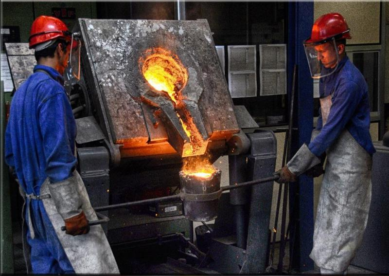
**Haut** : Coulée de fonte. Remplissage de la petite poche par basculement du four à induction. Les élèves doivent positionner la poche par rapport à l'écoulement de l'alliage liquide (environ 1400°C). Cette opération est particulièrement délicate.
