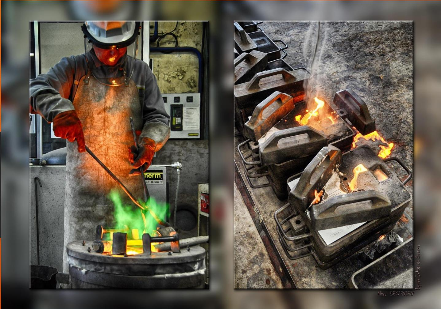
**Gauche** : Fusion de bronze au four à gaz propane. Vapeur d'oxyde de cuivre qui brûle donne cette couleur verte. Double jeu de reflet : la lumière se réfléchit sur la visière (côté extérieur) et est renvoyée sur le tablier (côté intérieur de la visière).
