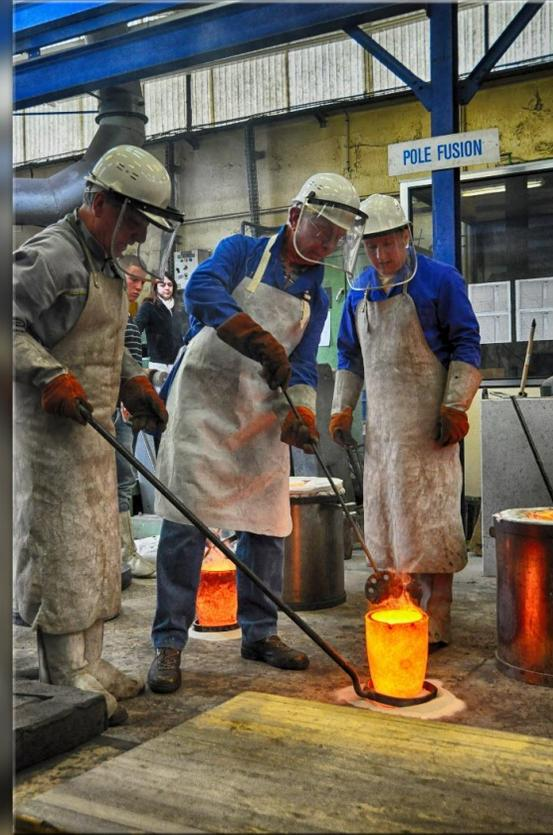
**Gauche** : Four à gaz (propane) en phase de préchauffage. Arrière-plan : caisse contenant l'alliage à fondre ainsi qu'une petite poche de coulée (fonte).
