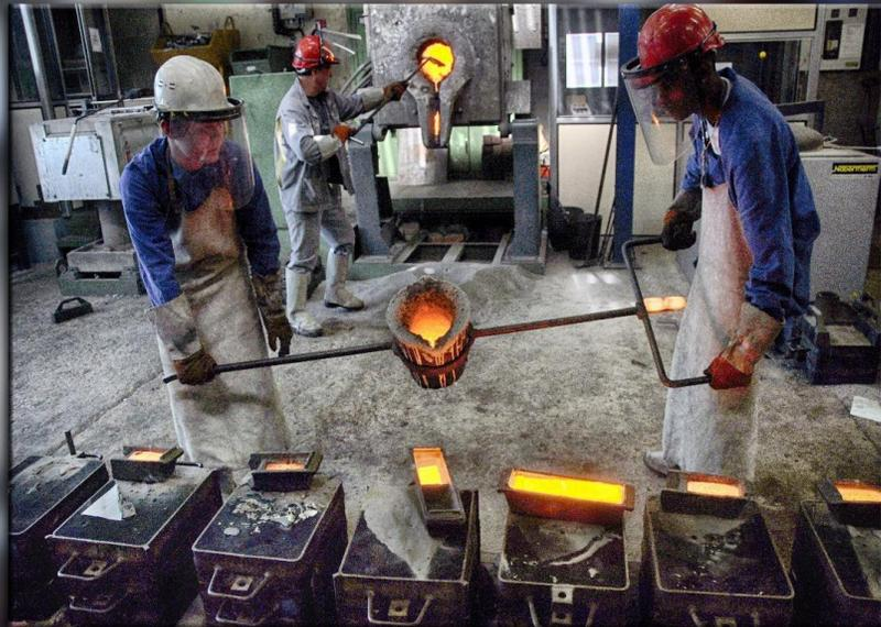
**Bas** : Coulée de fonte à la petite poche (avec un brancard). (Capacité 20 kg). Deux élèves coulent le reste de l'alliage dans les lingotières disposées sur des moules qui sont déjà coulés.
