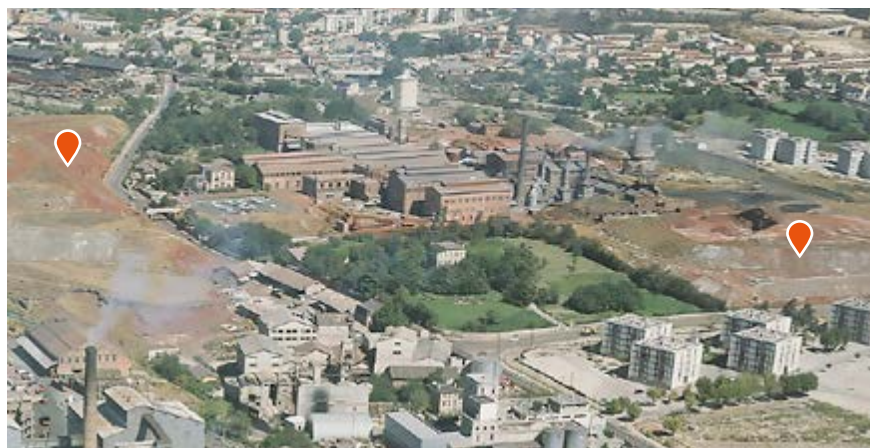
L'usine Saint-Louis-des-Aygalades et les dépôts des résidus « boues rouges » créés entre 1906 et 1953. Ils se présentent sous la forme de buttes de 10 à 15 m de hauteur sur une surface totale de cinq hectares. A la fin de l'exploitation, ce site a été en partie remodelé, couvert de terre et végétalisé - Source : Fonds Roger Henrard
