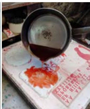
Moulage élastomère et coulage de cire
