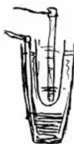
(G) - Croquis de Paul Héroult tracé sur un de ses cahiers de cours, à l'école préparatoire à l'école des mines (ci-dessous) - Schéma de principe du procédé dans le brevet déposé en 1886
