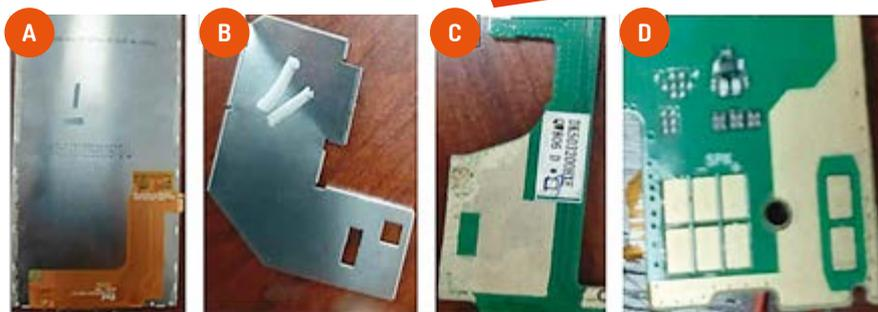
Fig. 2 : Pièces métalliques démontées de téléphones portables : (a et b) pièces de maintien en acier inoxydable et (c et d) pièces à base de cuivre du circuit imprimé.
