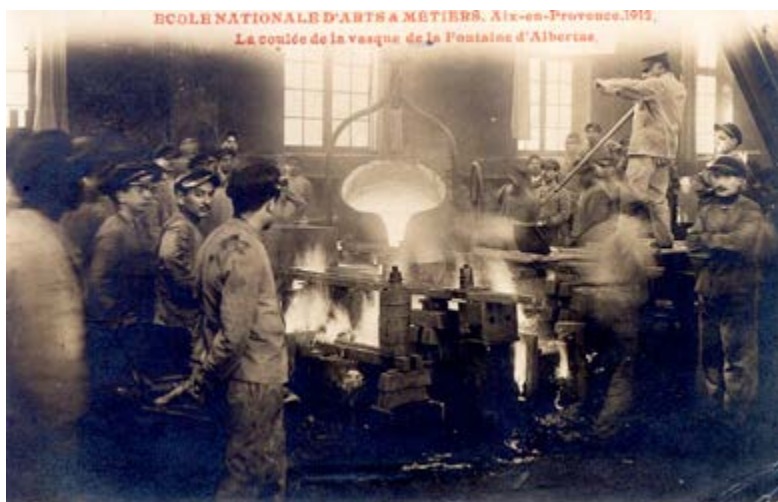
8 juin 1912 - L'élaboration de la fonte au cubilot et la coulée de la vasque Source : Photographie Henry ELY, Aix-en-Provence
