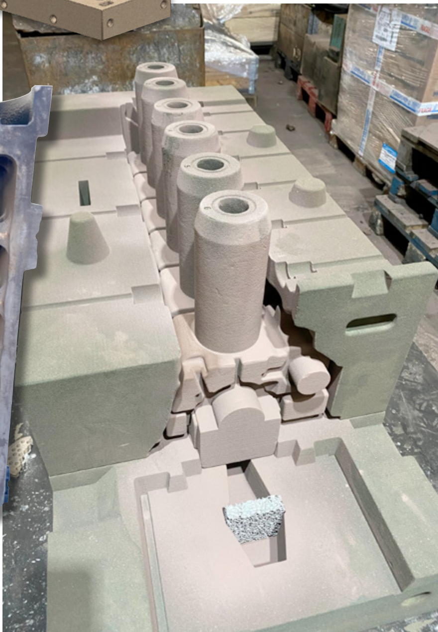
CAO du moule à gauche, Moule imprime en sable 3D ci-dessous avant la coulée en fonte
