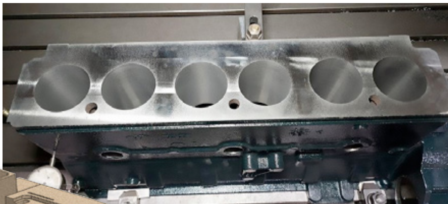
Bloc moteur brut de fonderie en bas à gauche, durant l'usinage ci-dessus.
