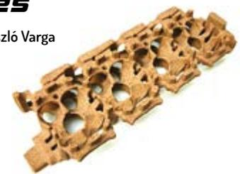
et de déformation à chaud. Il a été constaté que l'utilisation de sable régénéré permet de produire des noyaux présentant une résistance moyenne à la flexion supérieure et une déformation thermique inférieure. Ces différences peuvent être attribuées aux propriétés granulométriques plus avantageuses, à la plus faible teneur en impuretés et à la plus faible dilatation thermique du sable régénéré.
