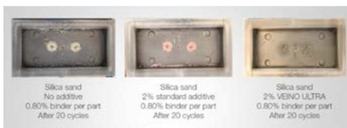
Fig. 3. Boîte à noyaux : comparaison d'additifs et résine (boîte froide) dessous les 2 inserts. Résultat après 20 cycles et sans application d'agent démoulant (lab. test).
