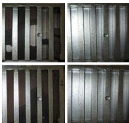
Fig. 9. Specimen pour tester le débouillage. Matière: aluminium, température de coulée: 650 °C, 1 coup = marteau picqueur à 2 bars; t = 3 secondes.
