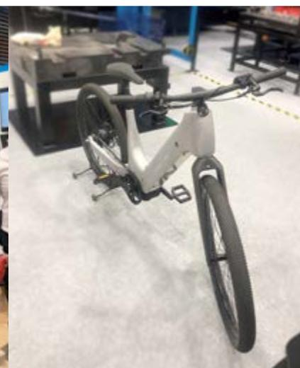
SAB et sa présence du côté des stands de la robotique, qui exposait non seulement ses produits mais aussi sa division robotique et une proposition de cadres de vélos électriques monoblocs compacts en aluminium. A l'instar de TESLA qui réalise ses structures aluminium sous pression, SAB propose une solution en une seule pièce pour les constructeurs de vélos électriques.
