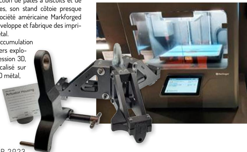
Une fois imprimée la pièce doit être déliantée (enlèvement de la part polymère + cire) dans une enceinte spécifique puis frittée dans un four de cuisson
