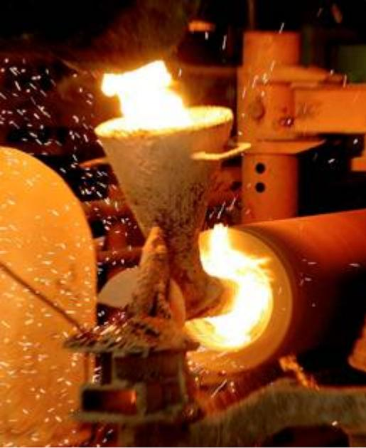
Nous découvrons tout d'abord le **côté centrifugation** qui se divise lui-même en centrifugation horizontale et centrifugation verticale. Les diamètres des tubes peuvent commencer à 30-50 mm pour aller jusqu'à 1,3m, pour des longueurs qui peuvent atteindre 6 m (selon les diamètres).
