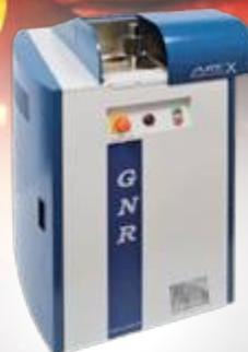
**DIFFRACTOMÈTRES DE RAYONS X**
