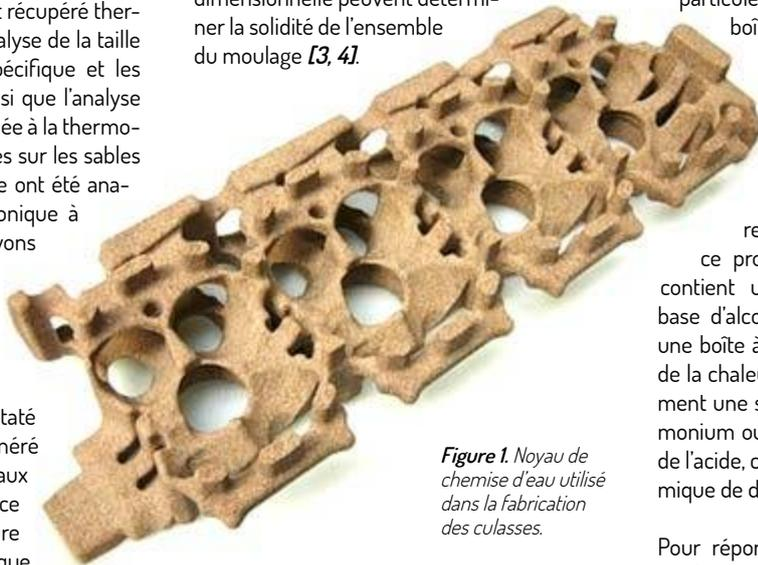
Figure 1. Noyau de chemise d'eau utilisé dans la fabrication des culasses.
