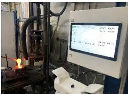
Figure 8. Presse automatisée, exemple de remplissage, relevés de températures dans l'empreinte instrumentée, CERFAV.
