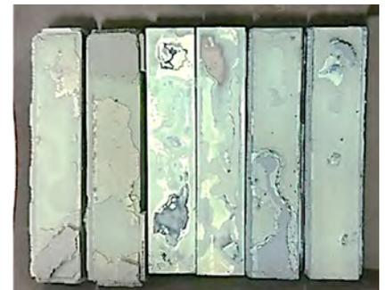
Figure 7. Délamination des carbures de tungstène après 25 cycles, ICAR.
