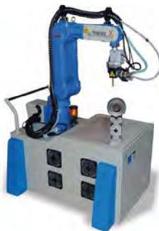
Mesure de stress / contrainte par diffraction de Rayon X
