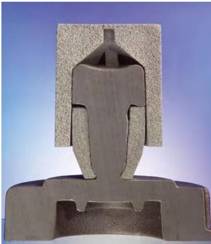
Figure 2 : Telefeeder et pièce coulée, vue en coupe
