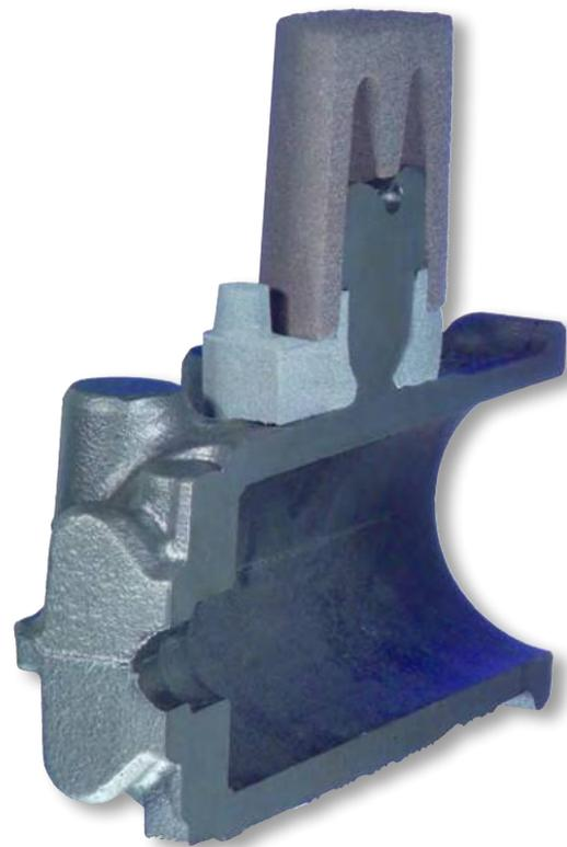
Figure 5 : Pièce coulée intégrant un assemblage Coldbox exothermique profilé avec manchon
