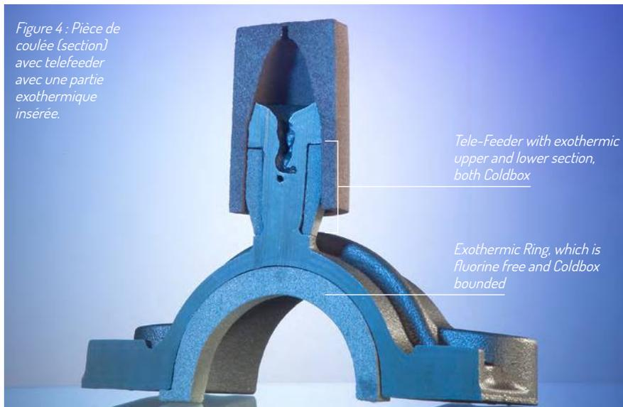
Figure 4 : Pièce de coulée (section) avec telefeeder avec une partie exothermique insérée.
