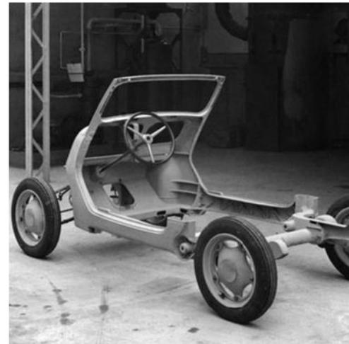
*AF-G (1942) 2 cylindres à plat / 594 cm<sup>3</sup> / 15 cv / 85 km/h. Carcasse coulée en Alpac.
