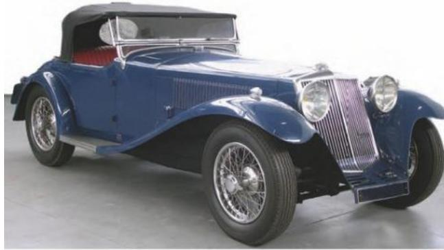
*Automobile Tracta E, type E1 1930. 6 cylindres - 2691 cm<sup>3</sup> - 52 cv - 120 km/h. Modèle produit par la Société Tracta, carrosserie Henri Chapron
