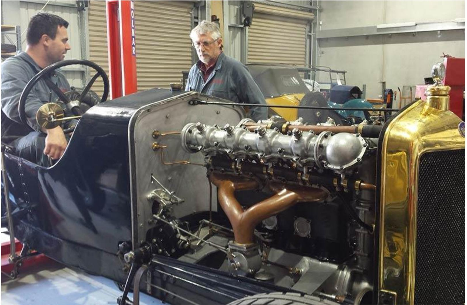
*1914 – DELAGE Type S – Premier moteur multicylindre 16 cylindres desmodromique.
