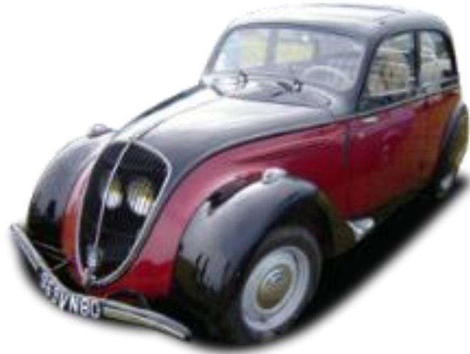
**Motorisation :** Propulsion, 4-cylindres, 1133 cm<sup>3</sup>, culbuté, bloc fonte et [culasse Alpax](#), 30 ch, boîte 3 vitesses, alimentation en 12 V, 100 km/h. Châssis séparé, roues AV indépendantes, pont AR rigide, freins à tambours à câbles.
