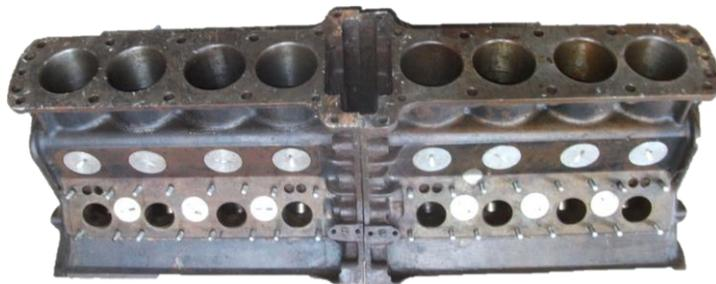
1931 - Alfa Romeo 8C 2300 – Bloc cylindres (en deux éléments) en Alpax
