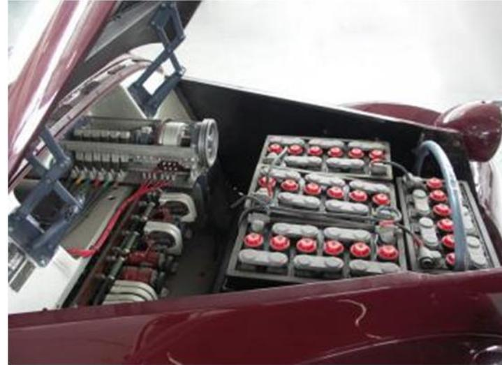
*La CGE-Tudor (1941) - Le châssis moulé en Alpac et Capot ouvert : les batteries avant vues de côté.*
