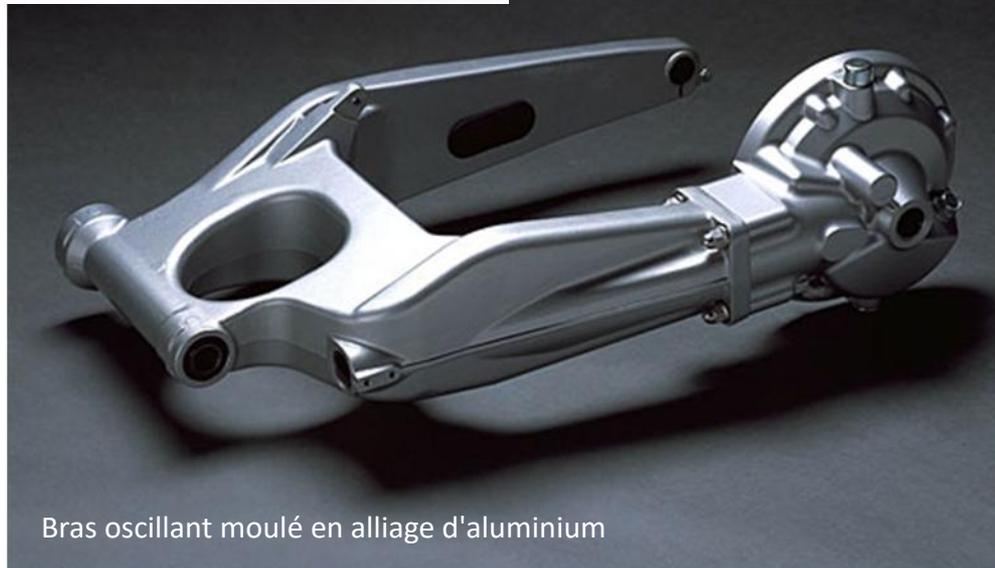
Bras oscillant moulé en alliage d'aluminium
