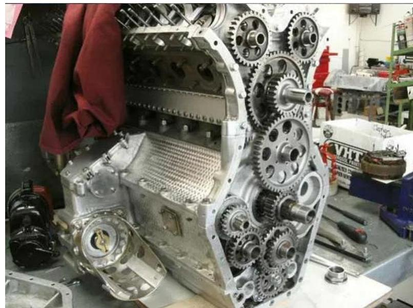
*DELAGE 15 8 S GP - Huit cylindres en ligne, 1488cc. Bloc cylindre borgne et carters en aluminium. Double arbre et double compresseur Roots soufflant vers deux carburateurs Zenith alimentés – Cascades de pignons commandant la distribution.*
