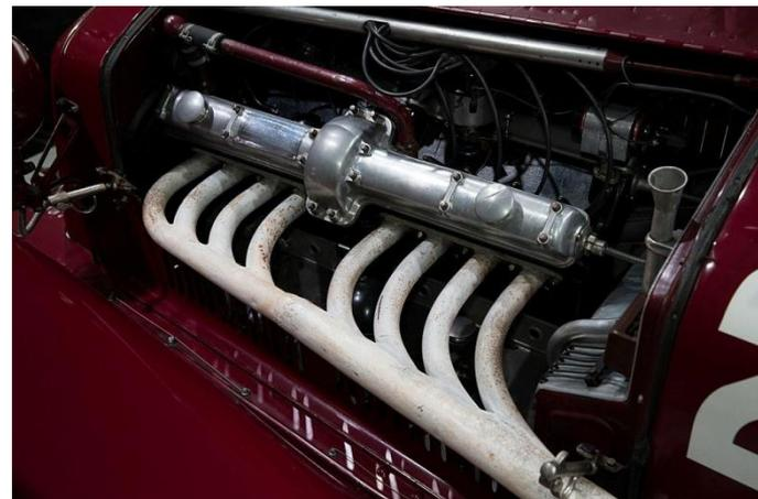
*1931 - Alfa Roméo 8C 2300. Motorisation 8 cylindres en deux blocs et 2 culasses en alliage d'aluminium Alpax*
