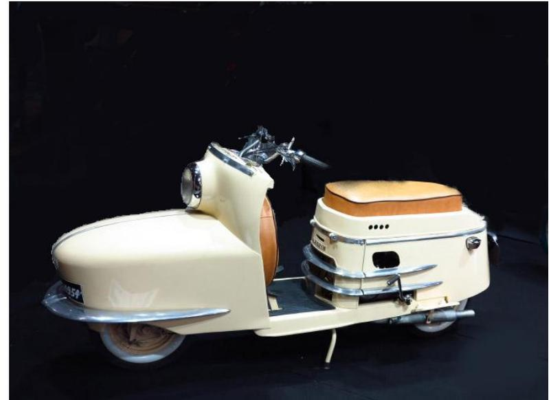
*Les coques avant et arrière, le tableau de bord et la fourche mono-bras sont des pièces moulées en Alpax.*
