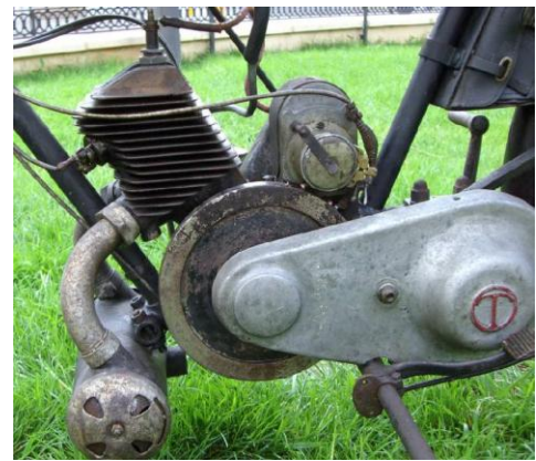
La boîte à vitesse est une Bridier-Charon type A. La marque de fonderie AC sur le fut du cylindre indique la fonderie ayant produit cette pièce : Auguste Collignon.
