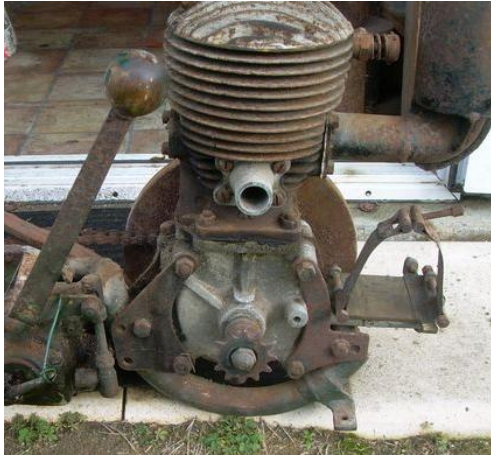
La boîte à vitesse est une Bridier-Charon type A. La marque de fonderie AC sur le fut du cylindre indique la fonderie ayant produit cette pièce : Auguste Collignon.
