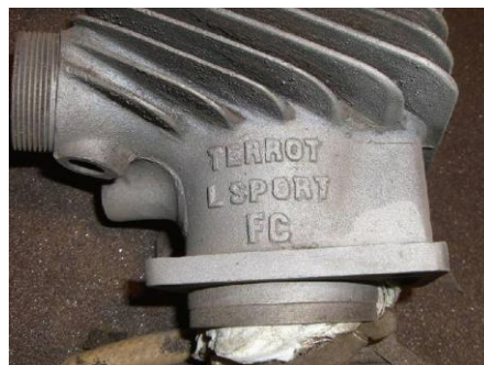
Le cylindre en fonte 2 sorties - les lettres FC indiquent qu'il provient de la "Fonderie Colignon"
