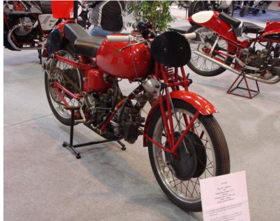
Moto Guzzi 250 Albatros 1947 Moteur monocylindre 1 ACT 246.8 cm 3 Puissance: 20ch à 7.000 tr/min Poids: 135 Kg Vitesse: plus de 140 Km/H
