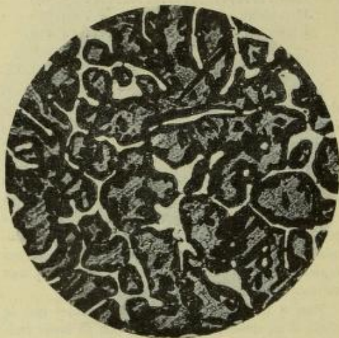
Fig. 7. — Laiton à 57 0/0 Cu et 1,73 0/0 P coulé en coquille. Solution \alpha + \beta' + \text{Cu}^3\text{P} Attaque oxydante \times 200
