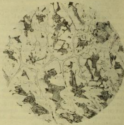
Fig. 5. — Laiton à 57,8 o/o Cu et 0,64 0/0 P coulé en sable Solution \alpha + \beta' + \text{Cu}^2\text{P} Attaque au perchlore de fer acide \times 200
