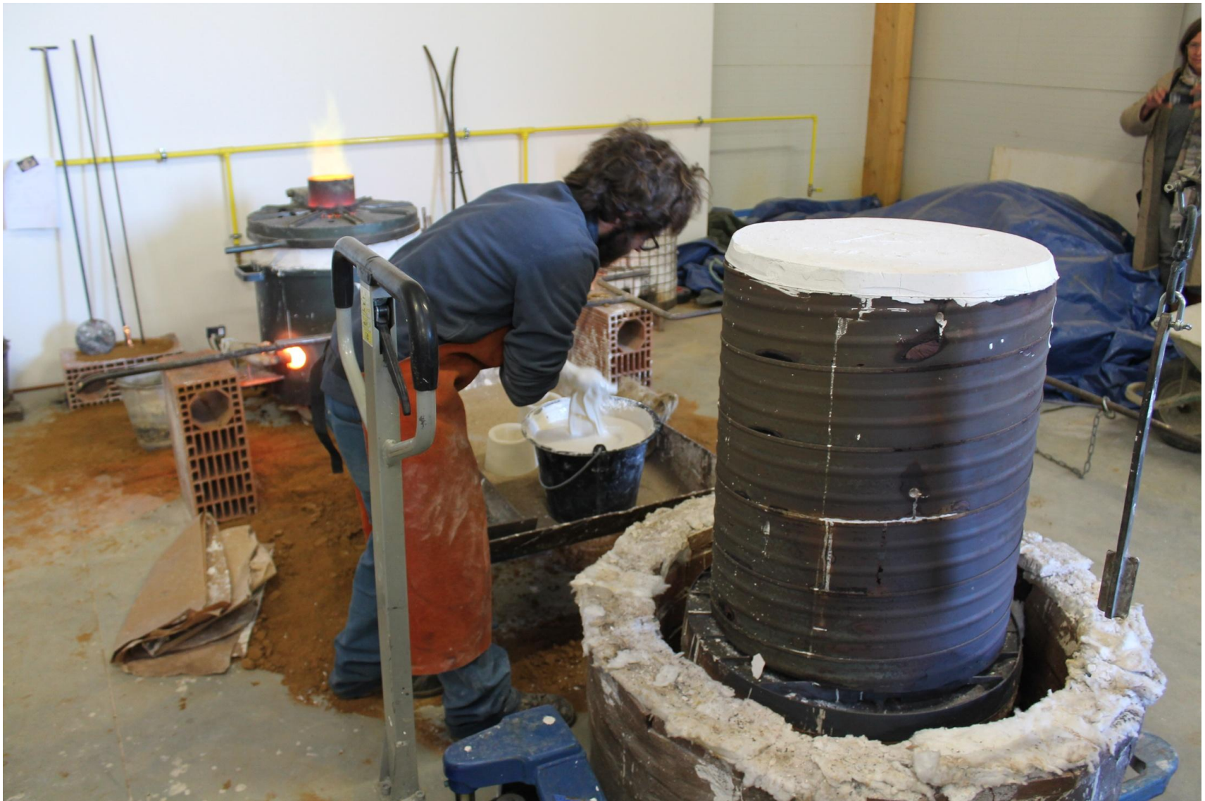
Le lutage du moule au plâtre (partie basse au moment de la coulée).
