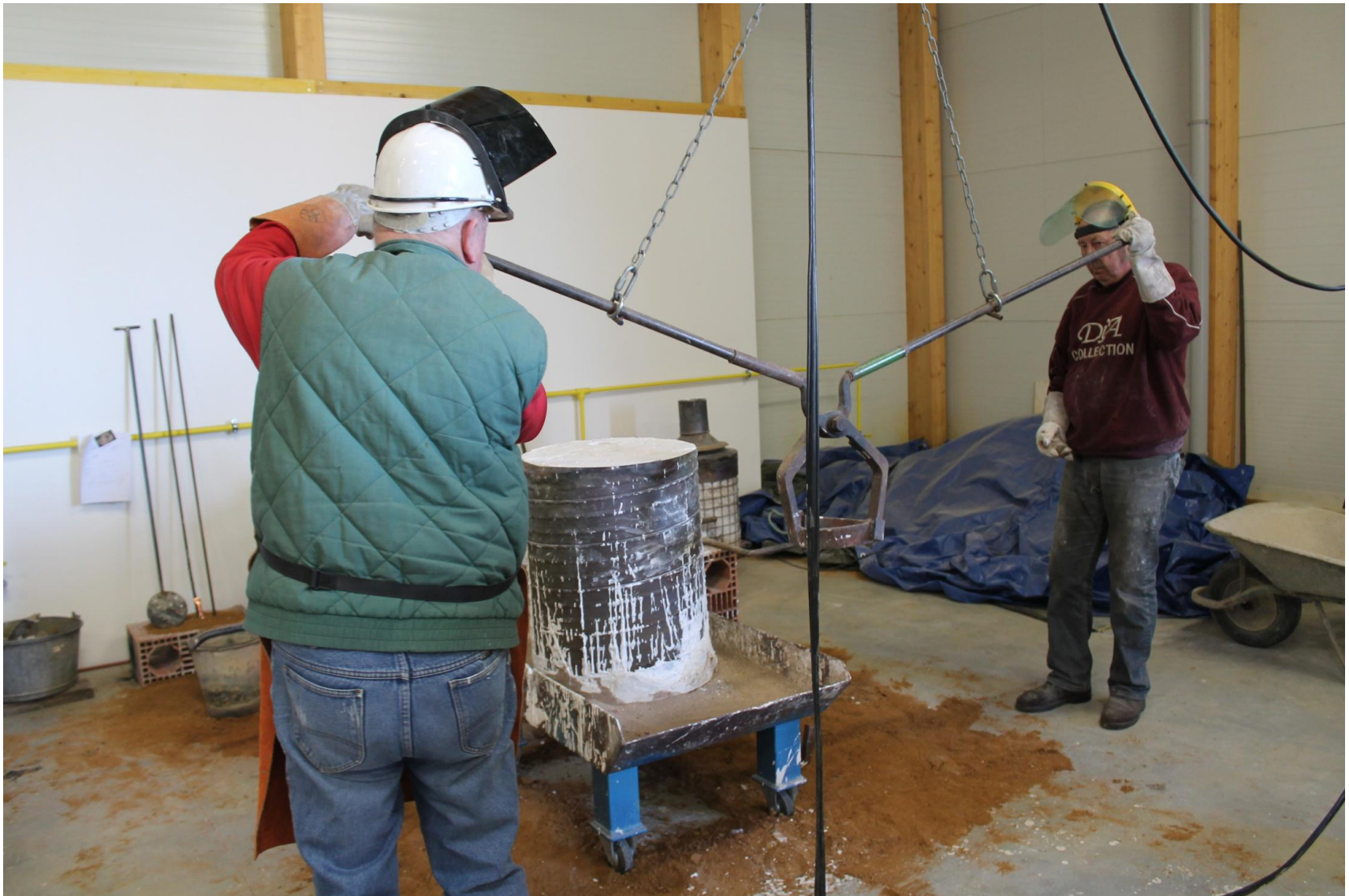
Préparation de la happe, celle-ci étant accrochée à un palan.
