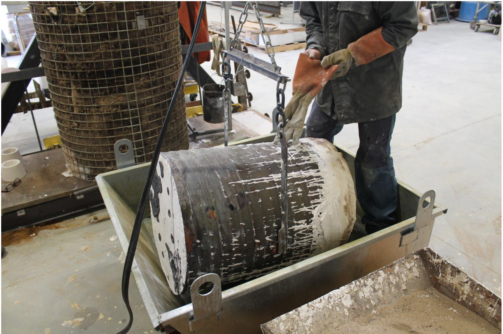
Le décochage : Après solidification du bronze, le moule basculé.
