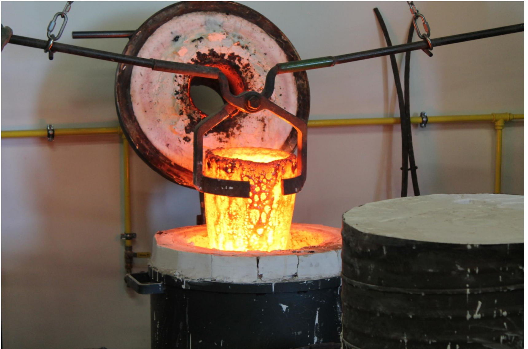
Sortie du creuset du four.
