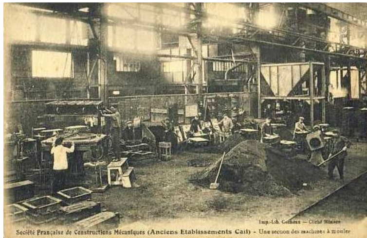
SFCM - Ateliers de Denain : Une section des machines à mouler.
