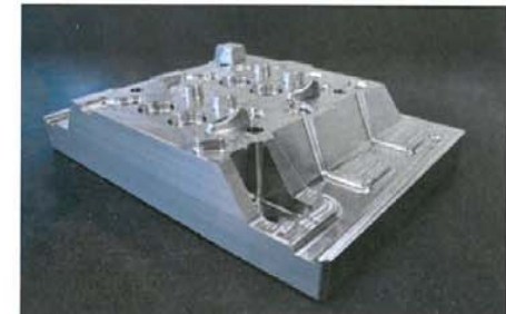
Outillage coquille acier pour culasse projet PROMAPAL pour Montupet
