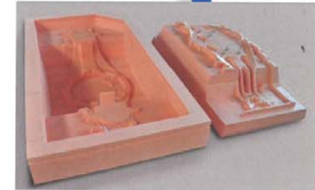
Modèle - boîte à noyau Ferroviaire (2000 x 800 x 500 ) Pour Fonderie de Montreuil et Brousseval
